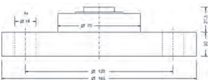
type G flange DIN EN 1092-1 A (B - DIN 2527), DN50, PN10-40
