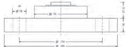
type F flange DIN EN 1092-1 A (B - DIN 2527), DN40, PN10-40
