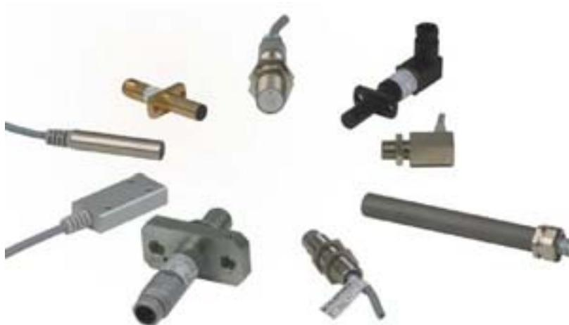
Импульсные датчики из конструктивного ряда магниточувствительных пригодны для регенерирования пропорциональных числу оборотов импульсных величин. Они снабжены или элементом Хола или магниторезистивным чувствительным элементом.
