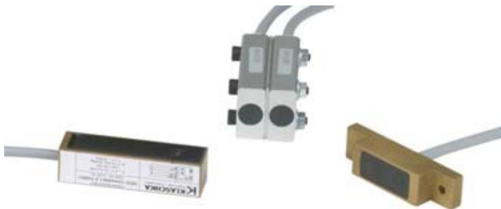
Датчики с двойным импульсом из конструктивного ряда магниточувствительных предназначены для генерирования серии импульсов, сдвинутых по фазе пропорциональных числу или частоте оборотов. Исходя из последовательности импульсов, пользователь может определять направление вращения или движения. В качестве чувствительных элементов для этих датчиков применяются по выбору статические элементы Холла или магниторезистивные элементы.
