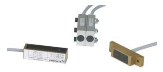
**Датчики с двойным импульсом** из конструктивного ряда **магниточувствительных** предназначены для генерирования серии импульсов, сдвинутых по фазе пропорциональных числу или частоте оборотов. Исходя из последовательности импульсов, пользователь может определять направление вращения или движения. В качестве чувствительных элементов для этих датчиков применяются по выбору статические элементы Холла или магниторезистивные элементы.
